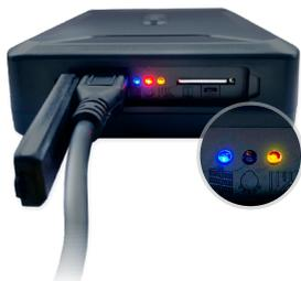
4. Attendere il completamento del processo di carica. Il dispositivo è completamente carico quando il LED rosso si spegne, vedere „1.9 Significato delle Luci LED“ di questo manuale.
