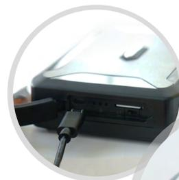
1. Connectez le câble de charge fourni avec l'aimant aux contacts du traceur GPS.
