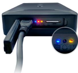
4. Espere hasta que se complete la carga. El aparato está completamente cargado cuando el LED rojo está apagado, véase „1.9 Significado de las luces LED“ en este manual.
