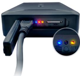
4. Warten Sie auf das Ende des Ladevorgangs. Das Gerät ist vollständig aufgeladen, wenn die rote LED erloschen ist, siehe „1.9 Bedeutung der LED Leuchten“ dieser Anleitung.
