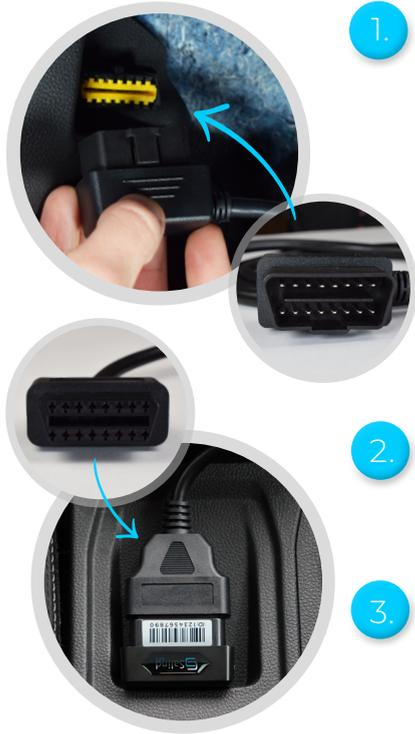
1. Inserte la punta abierta del cable de extensión, con agujas de contacto visibles, al puerto OBD de su vehículo hasta que encaje.
