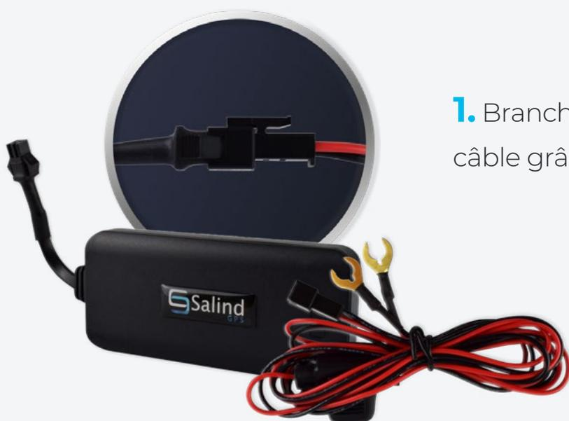
1. Branchez le Salind 01 au faisceau de câble grâce au connecteur noir.
